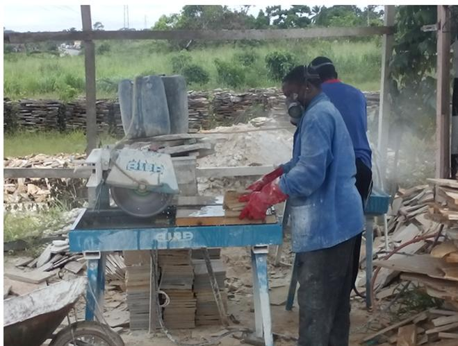
Figure 12: Scies diamantées fournies aux Gicamines de Pouma pour la taille des dalles de quartzite.
