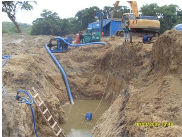
**Figure 15. Outils de l'artisanat semi – mécanisé : excavateur, unité de lavage, motopompe, groupe électrogène, et autres**
