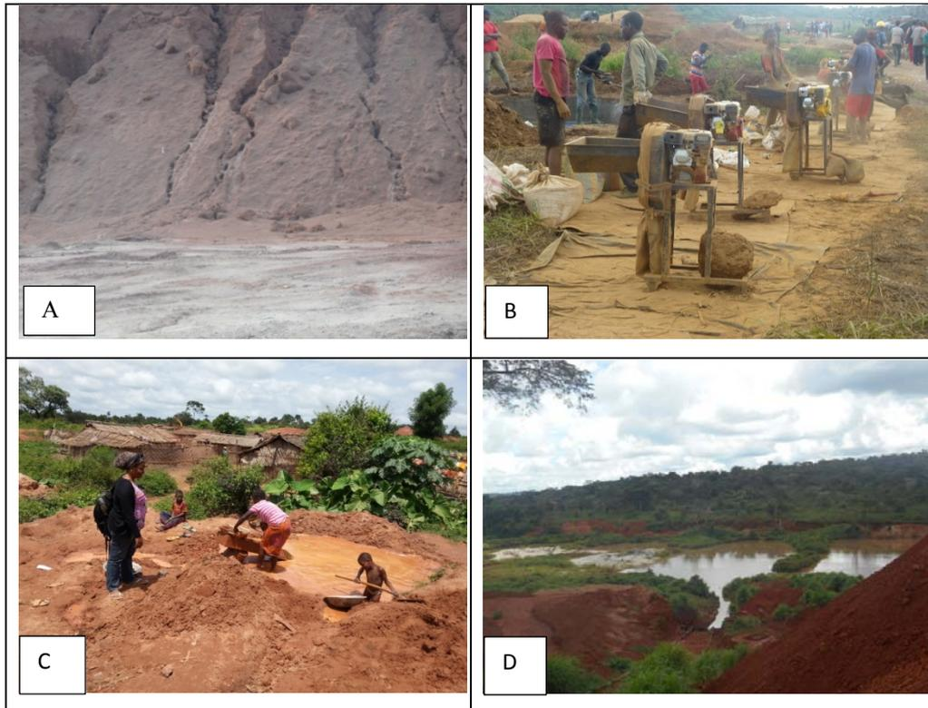
Figure 23. A) Risque d'écroulement de terrain ; B) Défrichement et érosion des sols ; C) Inhalation de poussières lors du concassage ; D) Risques de chutes et de noyade.
