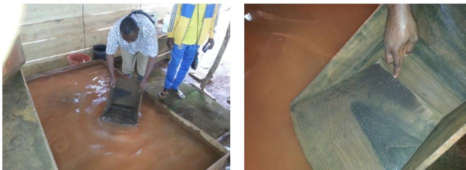
Figure 19. Bac de rinçage dans une structure semi-mécanisée avec amalgamation de l'or par le mercure
