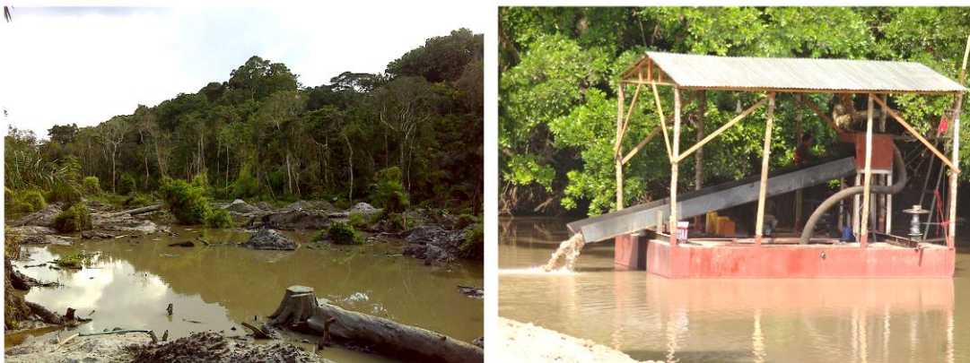
Figure 1 gauche : site minier artisanal abandonné (exploitation alluvionnaire manuelle) de « Boule d'or », région de Mintom (Région Sud, 2013); droite : petit ponton chinois avec tube d'aspiration et sluice (Rivière de la Kadéï à Taparé, Région Est, 2014)
