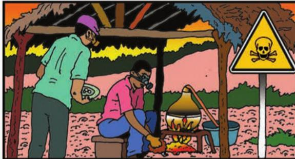
Après la concentration au sluice et la réalisation de l'amalgame, au lieu de jeter la bassine de restes (les rejets) au sol, il existe des techniques de recyclage du mercure...
