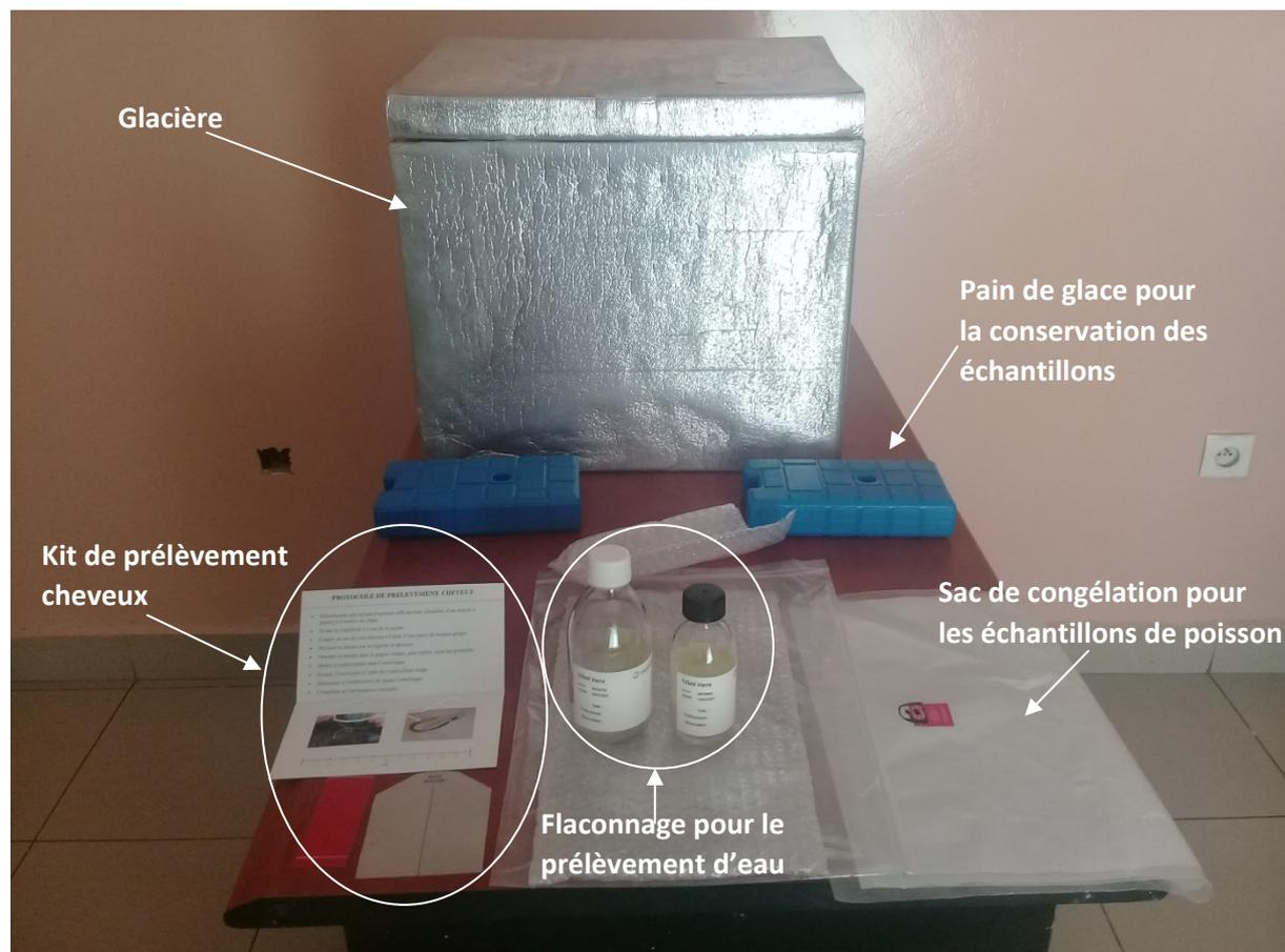
**Figure 9.** Matériel pour le flaconnage et le conditionnement des échantillons depuis le site de prélèvement jusqu'au Laboratoire d'analyse.
