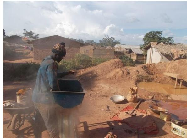
Figure 62 à gauche : Exploitation artisanale souterraine d'une zone de stockwork altérée à Boukarou (Kambele III) en 2014 ; à droite : Concassage / broyage du matériel des veines de quartz, avec développement permanent des poussières
