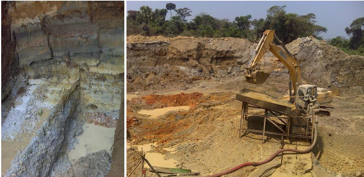
Figure 54 à gauche: profile sédimentaire typique dans les flats de la zone de Bétaré Oya : gravier grossier de ca. 1 m d'épaisseur couvert par du sable et du silt argilleux. A droite: excavation du gravier de la rivière Nakoyo à Bétaré Oya par une compagnie Chinoise en 2013. Lavage à l'intérieur du puit avec des stations mobiles.
