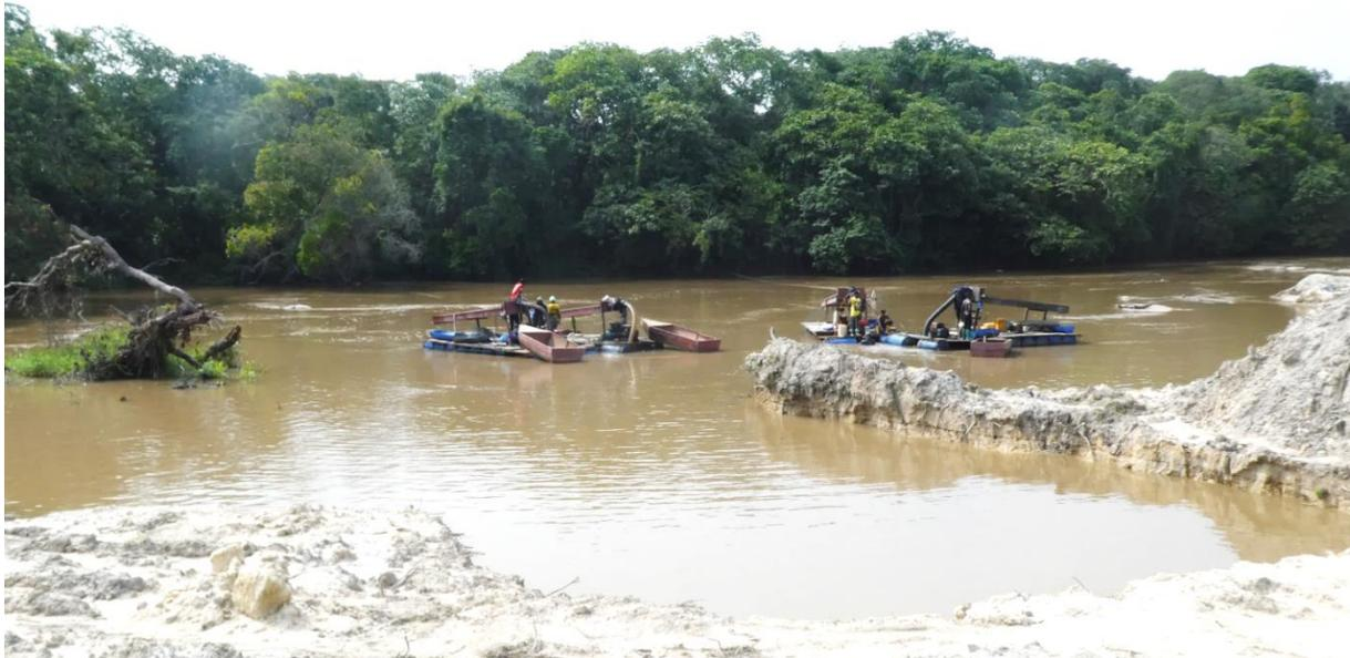
Figure 57 Pontons de dragage à la Kadeï au SE de Colomines (MS-CM31)
