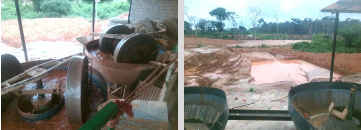
*Figure 66 Station de broyage et de lavage; à gauche : broyage des roches primaires à l'aide de roues métalliques tournant dans des bassins ; à droite : petit bassin de décantation, insuffisant pour empêcher la pénétration des boues dans la vallée du Mbil (OP-CM08).*
