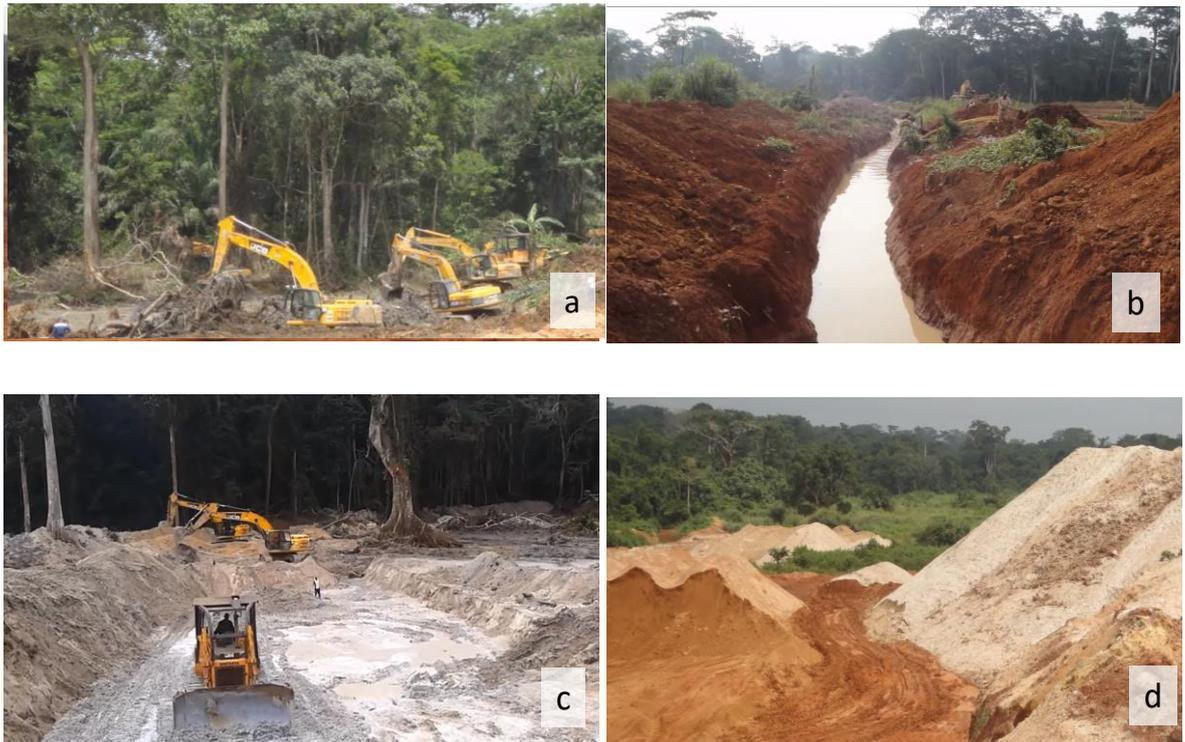
Figure 50 Préparation de l'exploitation alluvionnaire sémi-mécanisée: a) défrichage, b) déviation de la rivière dans un canal, c) enlèvement du sol, d) recouvrement empilé ; Opération de Metalicon S.A. à la rivière du Djongo, Kambele, 2013 [13]
