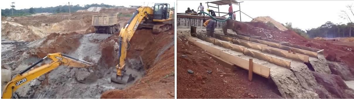
Figure 52 à gauche : enlèvement du gravier et chargement sur le camion ; à droite : lavage à la sluice [13]
